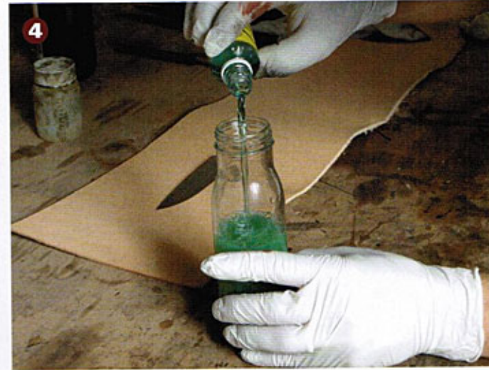
4 Vorbereitung: Wir füllen die Schnellbrünierung in ein schlankes Glasgefäß um, damit wir die Klinge eintauchen können.
