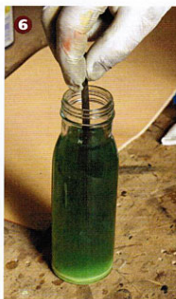
6 Tauchbad: Wir halten die Klinge für wenige Minuten in die Brünierlösung. Sie nimmt rasch eine dunkle Farbe an.
