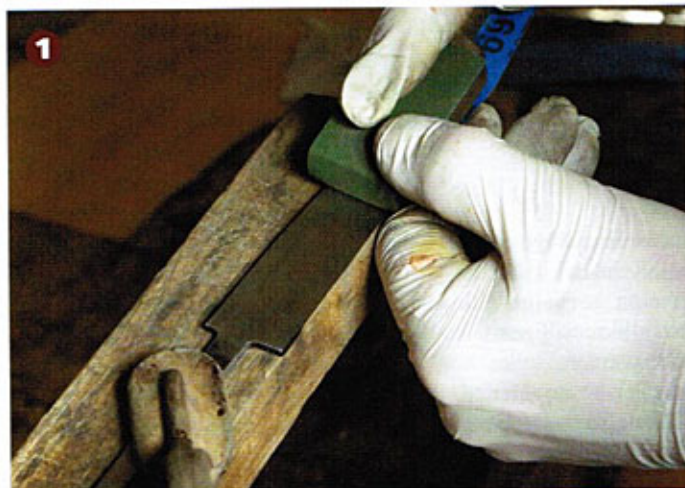
1 Finish: Vor dem Brünieren muss die Oberfläche sauber bearbeitet werden, denn die Brünierung verdeckt keine Kratzer und Schlieren.
