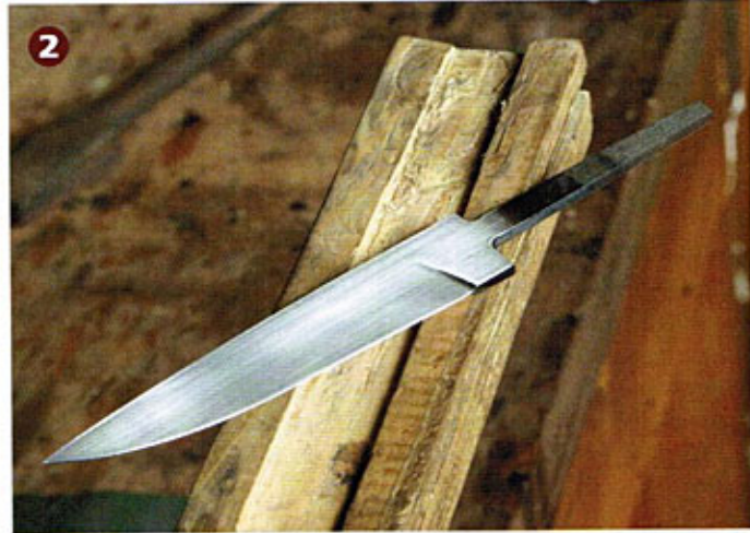
2 Geschmacksfrage: Ob die Oberfläche satiniert ist wie auf dem Foto oder auf Hochglanz poliert, spielt für die Haftung der Brünierung keine Rolle.
