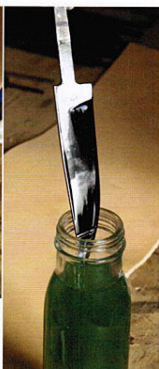
6 Tauchbad: Wir halten die Klinge für wenige Minuten in die Brünierlösung. Sie nimmt rasch eine dunkle Farbe an.
