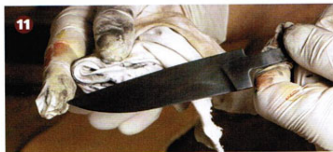
11 Fast fertig: Die Brünierung sieht jetzt schon sehr anständig aus. Sie ist auch rundum gleichmäßig gelungen.
